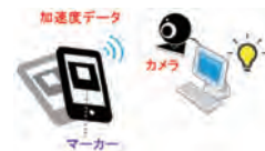
図1:カメラと加速度センサーを利用したペアリング手法
