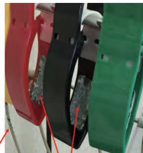
ペーストが拭き取られていないままの心電計電極
