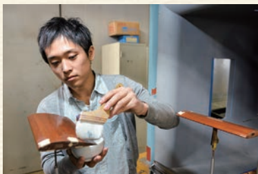
翼の表面に流れる風を可視化する実験です。
