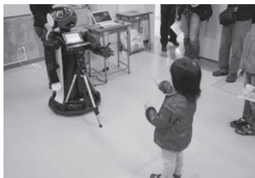
<吉野研究室>深度センサ (Kinect2) を使ってお子様の手の形状を判断し「ノワール」とジャンケンを行うデモ
