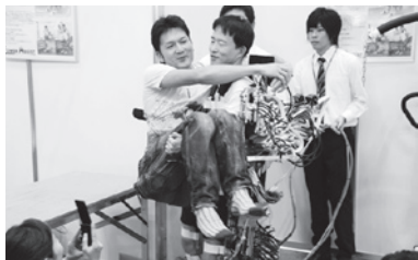
パワーアシストスーツを着用し、男性を抱き上げるデモンストレーションの様子
