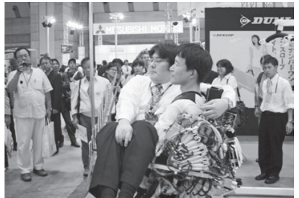
パワーアシストスーツを着用し、男性を抱き上げるデモンストレーションの様子
